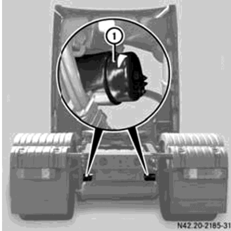
محل قرارگیری سیلندره‌های (بوسترهای) فنری ترمز پارک (مثال: خودروکشنده تریلر)
